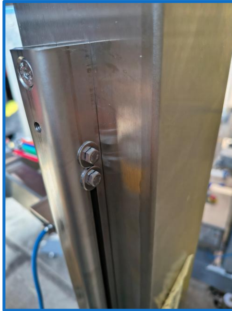
Instructie 2: hoogte van de sensor aanpassen
