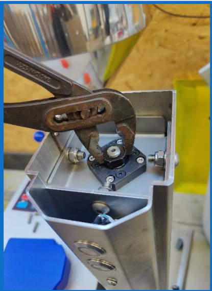
Instructie 3: Draai handmatig de spindel
