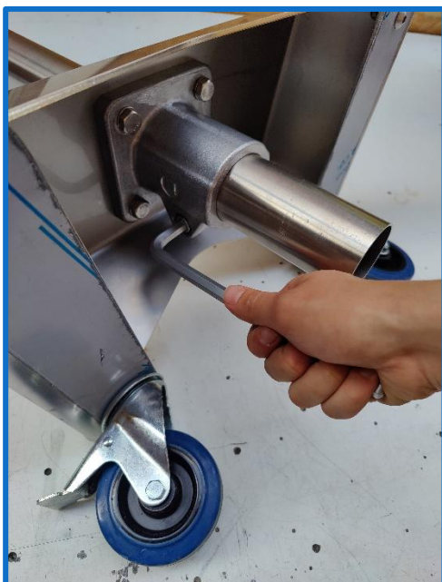
Instructie 1: Loshalen van de klembus
