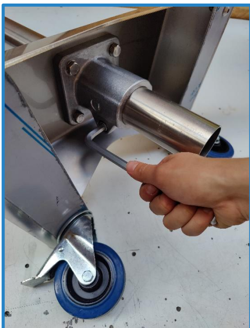
Instructie 1: Loshalen van de klembus
