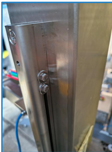
Instructie 2: hoogte van de sensor aanpassen
