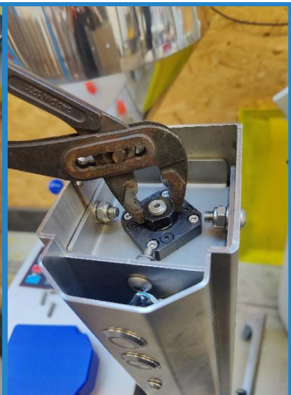
Instructie 3: Draai handmatig de spindel
