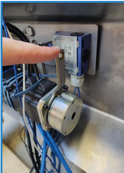
Instructie 1: Ontkoppel de rem
