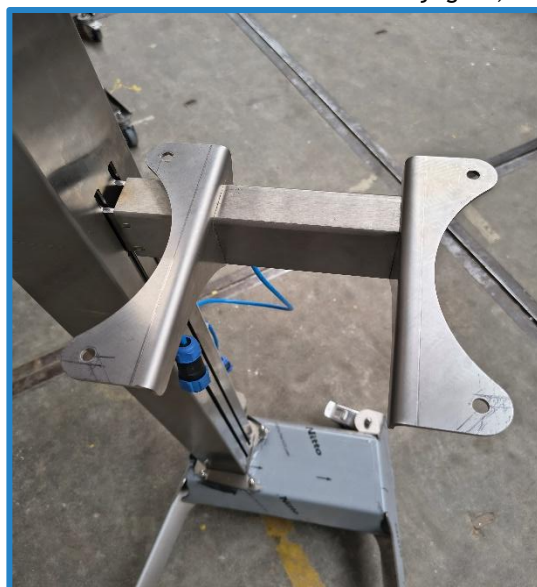
Montageplaat van de E-Plopper op de Liftkar
